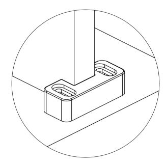
POSITION THE SCREEN SUPPORT FEET EITHER SIDE OF THE GLASS PANEL AND FIT.
